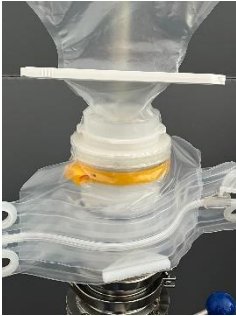
Abb: QuickTric Gesamtinstallation mit Flecozip Sekundäreinhausung
