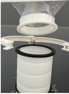
Abb: Konventionelle Standard Tri-Clamp Schnittstelle
