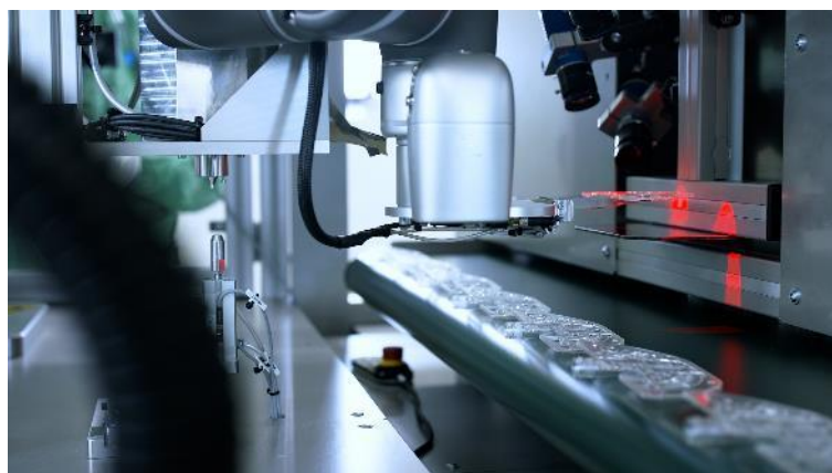
Bild 2: Mittels vollautomatischer Kameraprüfung werden die korrekte Befüllung und Bestückung der PCR-Testkartusche kontrolliert. Bild: © Rodinger Kunststoff-Technik GmbH
