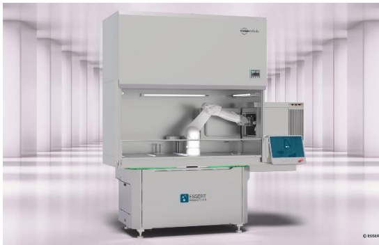
In der wegweisenden Pipettierzelle kommt ein Stäubli TX2-60L in Stericlean Ausführung zum Einsatz. Foto: ESSERT Robotics
