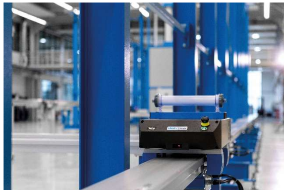
Das batteriebetriebene STEIN link-Shuttle transportiert einen Dialysefilter auf dem Aluminium-Streckenprofil.
