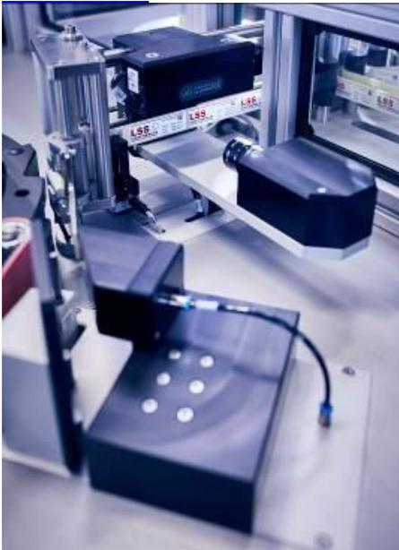
Per visueller Qualitätskontrolle werden fehlerhafte Etiketten vor der Anbringung aussortiert. (©LSS)
