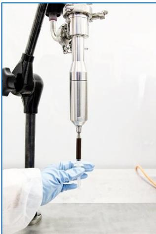
*(Quelle: ViscoTec) Spritzenabfüllung halbautomatisch*
