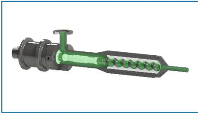
*(Quelle: ViscoTec) Pharma Abfüllpumpe Schnittzeichnung*
