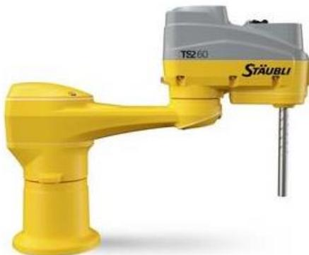
Die brandneue SCARA-Baureihe TS2 ist jetzt modular aufgebaut und verfügt erstmals über die Staubli eigene JCS-Antriebstechnik.
