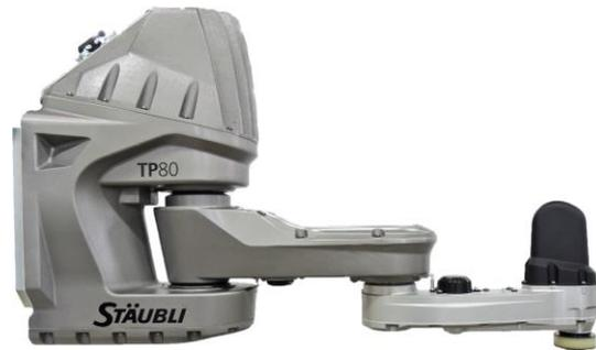
Mit den Optionen HE und H1 wird der FAST picker TP80 he zum perfekten Highspeed-Roboter für Verpackungsapplikationen unter Reinraumbedingungen.
