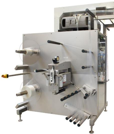
„Wir haben an allen Abwicklungen der Bahnware Autosplicer integriert“, erläutert Projektleiter Florian Härpfer. Der große Vorteil dieser Technologie: Die Autosplicer ermöglichen einen kontinuierlichen Prozess, da die Anlage für Rollenwechsel nicht gestoppt werden muss.
