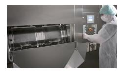
Bildunterschrift: Waschen, Sterilisieren und Silikonisieren pharmazeutischer Gummi- und Kunststoffkomponenten mit Waschanlagen von PTA
