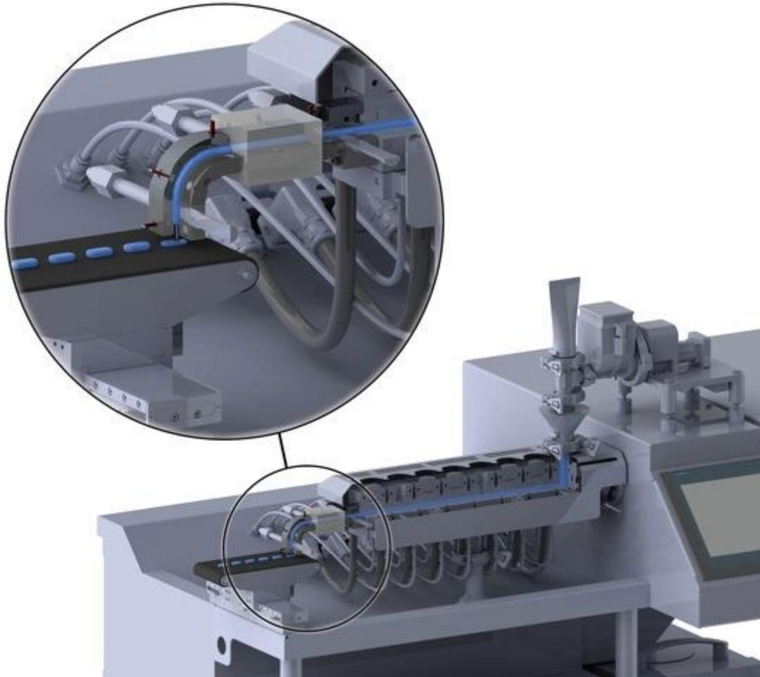
Konzept für den Einsatz des 3D-Drucks in der pharmazeutischen Produktion: Im Schmelzextruder (rechts) werden die Ausgangssubstanzen aufgeschmolzen und mit dem Drucksystem (links) in Tablettenform gebracht. (Grafik: TH Köln)
