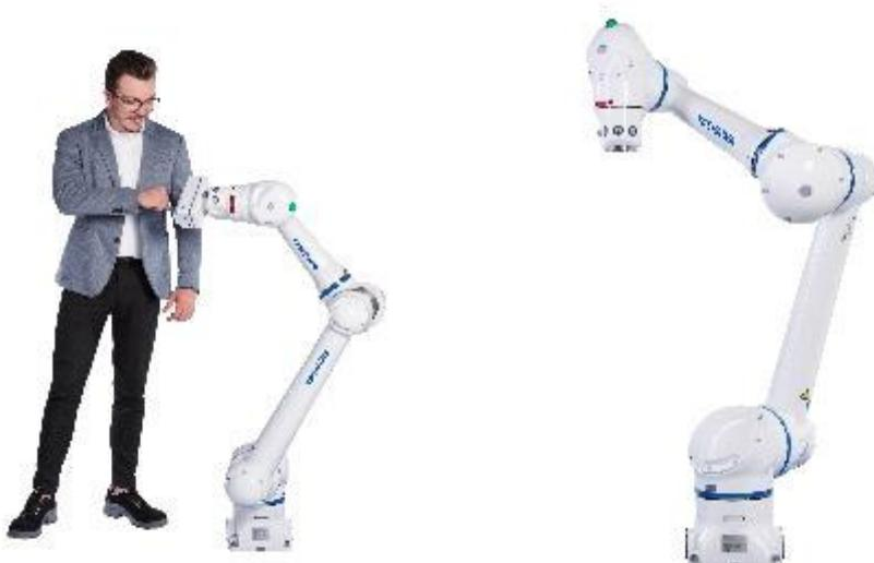
Mit dem neuen Motoman HC10DT IP67 stellt Yaskawa eine staub- und wasserdichte Variante des MRK-fähigen Basismodells vor. (Quelle: Yaskawa)
