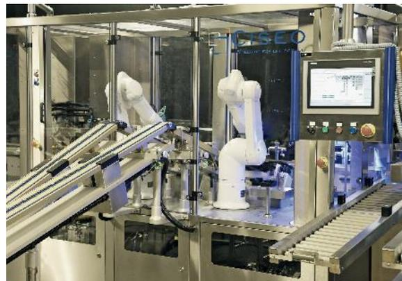
Mit einer Taktrate von 600 Einheiten pro Minute übernehmen zwei Stäubli-Sechssachs-Roboter das Vereinzeln von leeren und das Gruppieren von gefüllten Glasbehältern.
