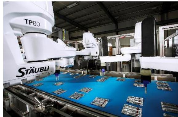
Aufgrund der herausragenden Beständigkeit gegen Reinigungsprozedere zum Schutz gegen Bakterien gelten Stäubli Roboter heute als Benchmark in vielen sensiblen Einsätzen.
