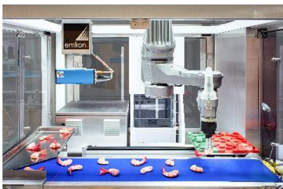
Die modifizierte Sonderausführung unserer FAST picker TP80 he gilt als der einzige Clean-Picker weltweit. Die High-Speed-Verpackungszelle wird ermöglicht durch 3D-Roboterführung.
