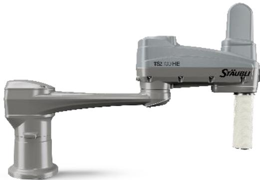
TS2-100 he SCARA-Roboter – 1000 mm Reichweite, designed für Palettier- und Verpackungs-Anwendungen im Lebensmittelbereich.
