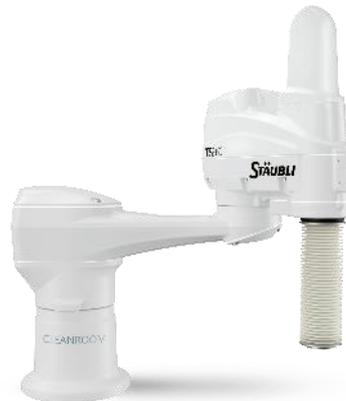
Durch die vollständig gekapselte Bauweise der Cleanroom-Roboter gelten diese als erste Wahl für Einsätze im Kosmetik-, Medizin- und Pharmabereich.
