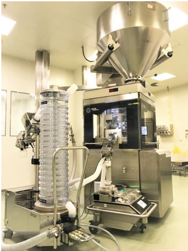
Bei Aenova in Regensburg können nun im Bereich hochpotenter Produkte fast 1 Mio. Tabletten pro Stunde produziert werden. (Foto: Aenova Group)
