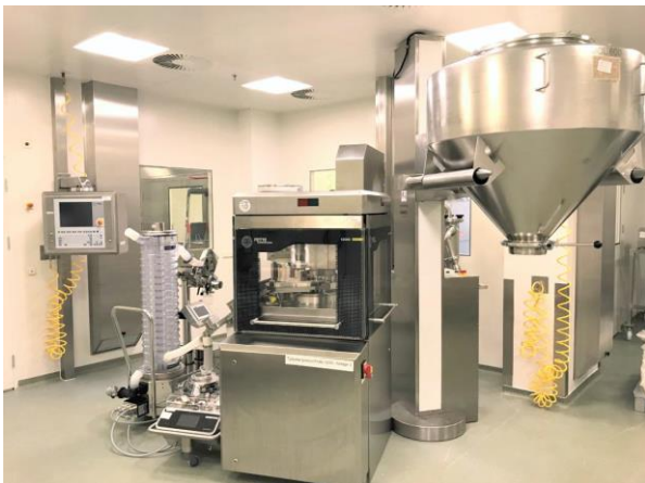
Die neue Tablettenpresse bei Aenova in Regensburg für hochpotente Wirkstoffe ermöglicht eine flexible high containment-Produktion. (Foto: Aenova Group)
