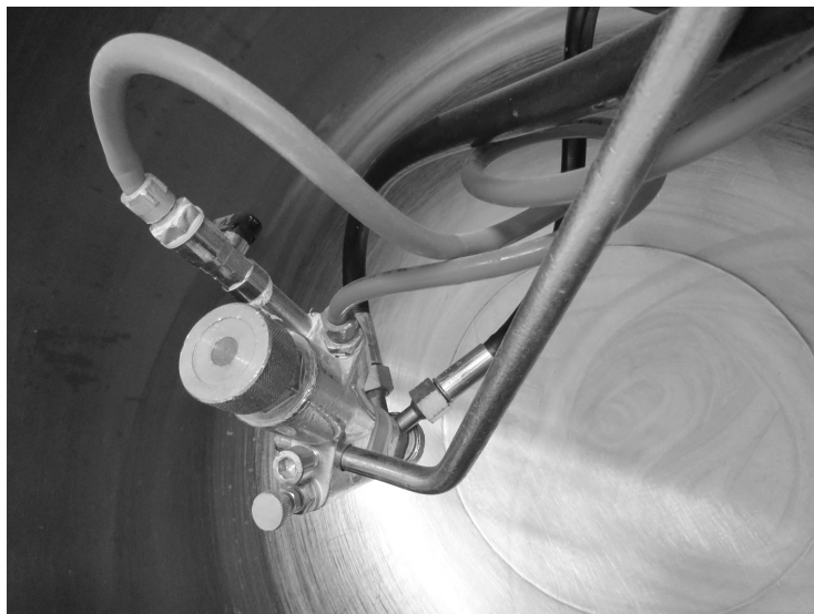
Abb. 3. Zweistoffdüse mit Anschlüssen für das flüssige Medium, Druckluft zur Ansaugung des Mediums und Druckluft zum Versprühen des Mediums. © WALTHER PILOT, Wuppertal.
